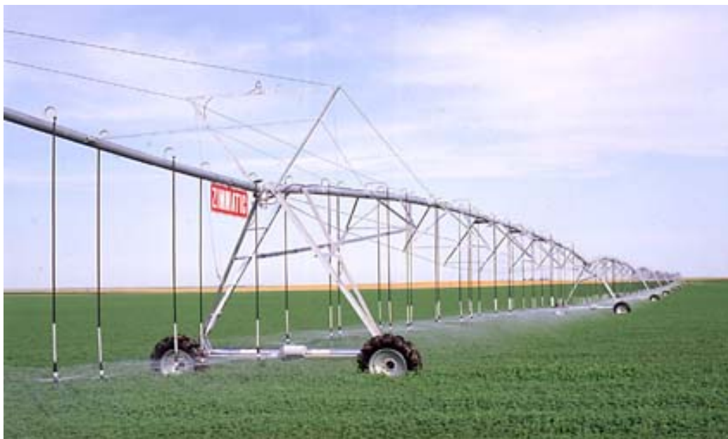
9.2 ábra Lineár öntözőberendezés kisnyomású szórófejekkel
